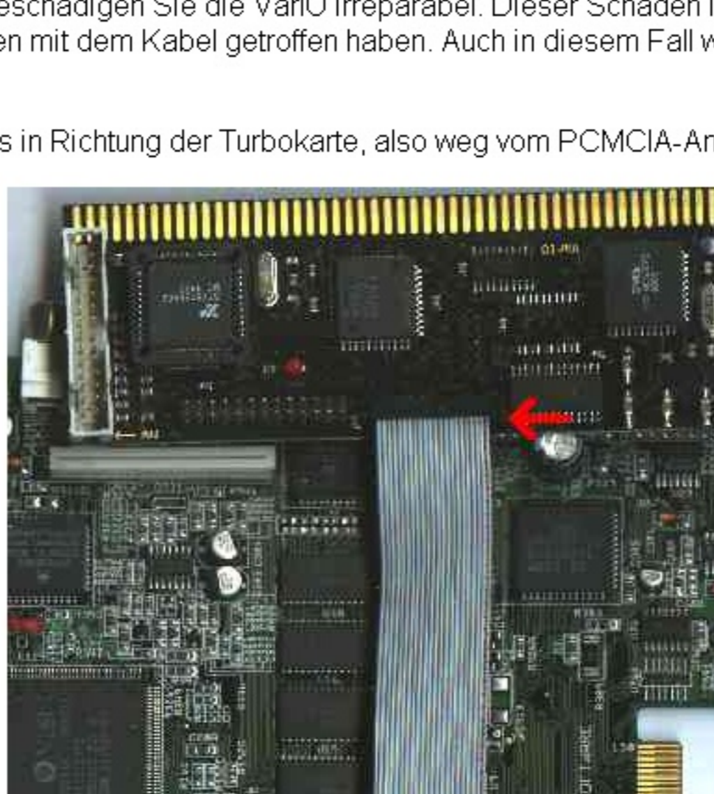
Anschluß einer VarIO auf dem Uhrenport des A1200
