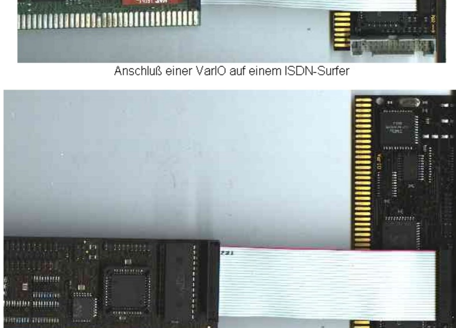
Anschluß einer VarIO auf einem Buddha Flash IDE controller
