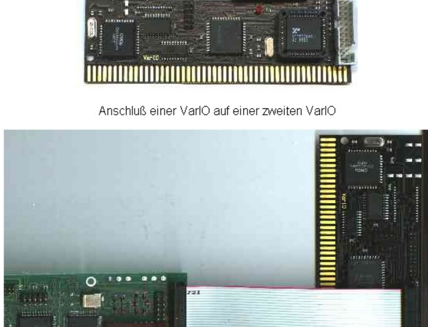
Anschluß einer VarIO auf einem ISDN-Surfer
