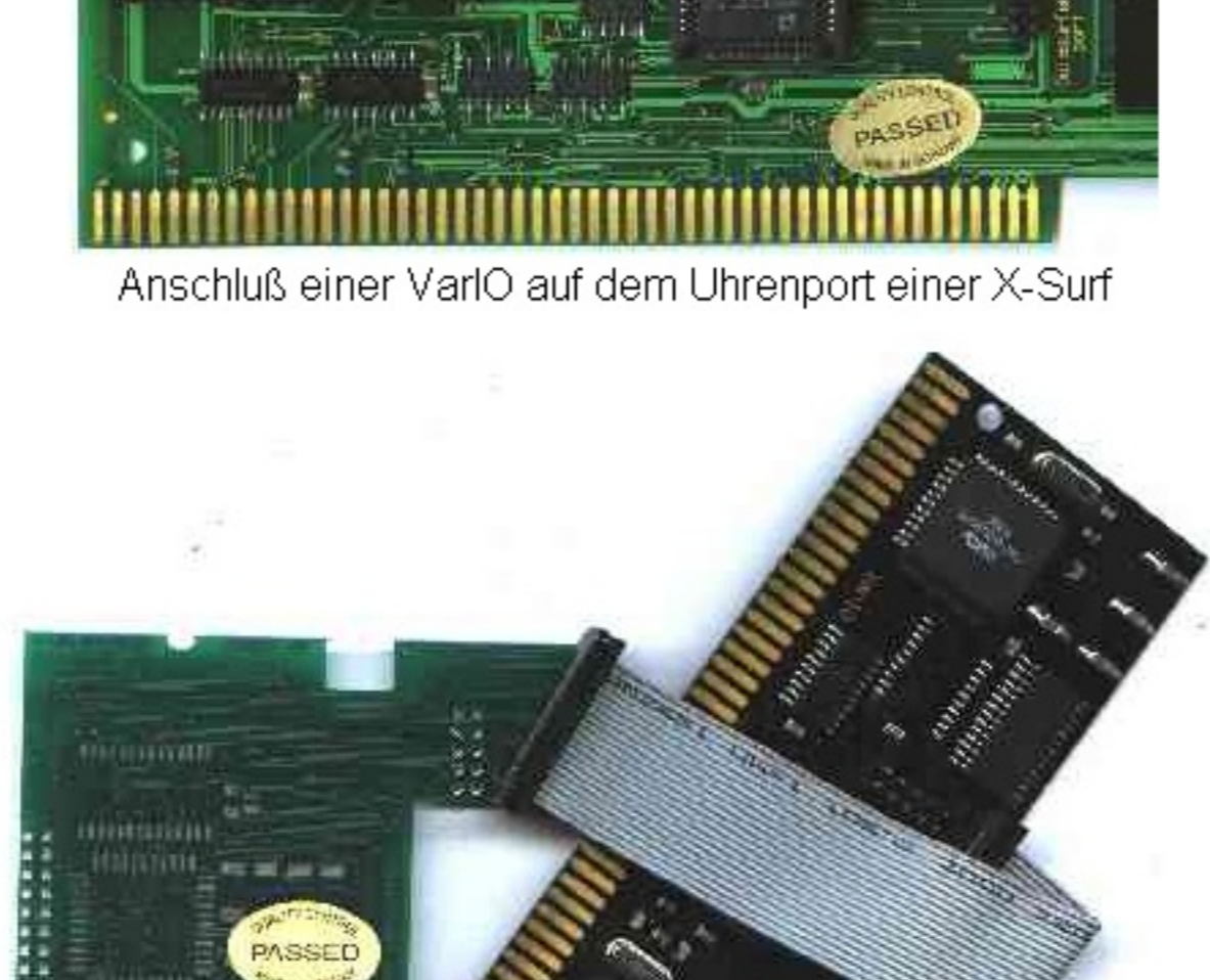
Anschluß einer VarIO auf dem A600-Adapter (derzeit von der Treibersoftware nicht unterstützt)
