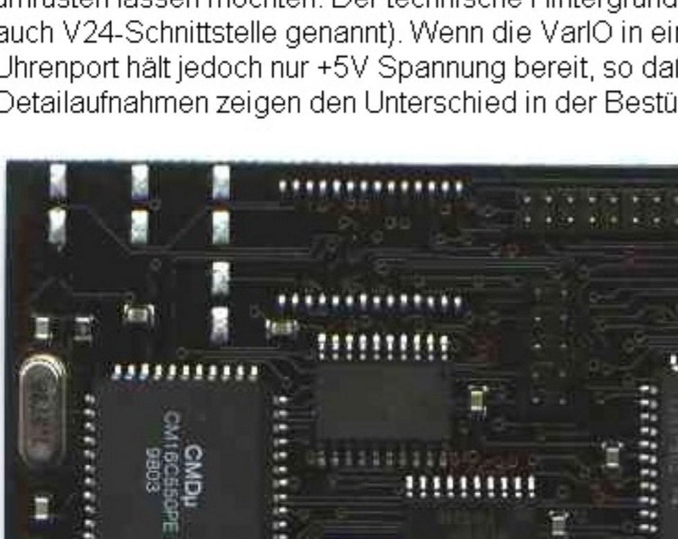
Pegelwandler der VarIO für Zorro/26-pin Betrieb
