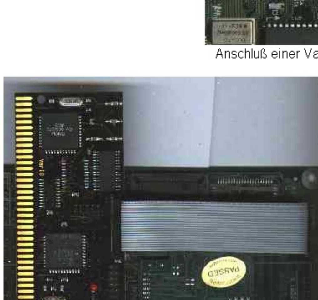
Anschluß einer VarIO auf einem Uhrenport des Z4 Board
