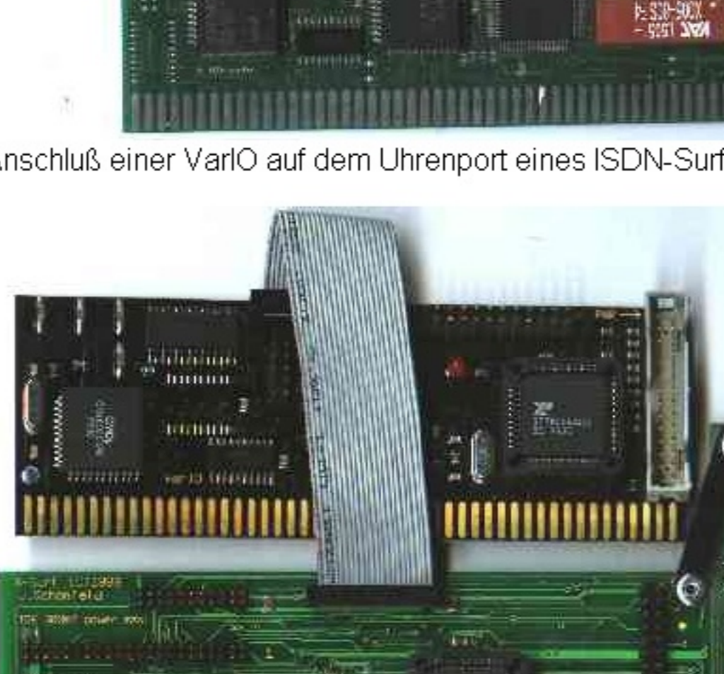
Anschluß einer VarIO auf dem Uhrenport einer X-Surf
