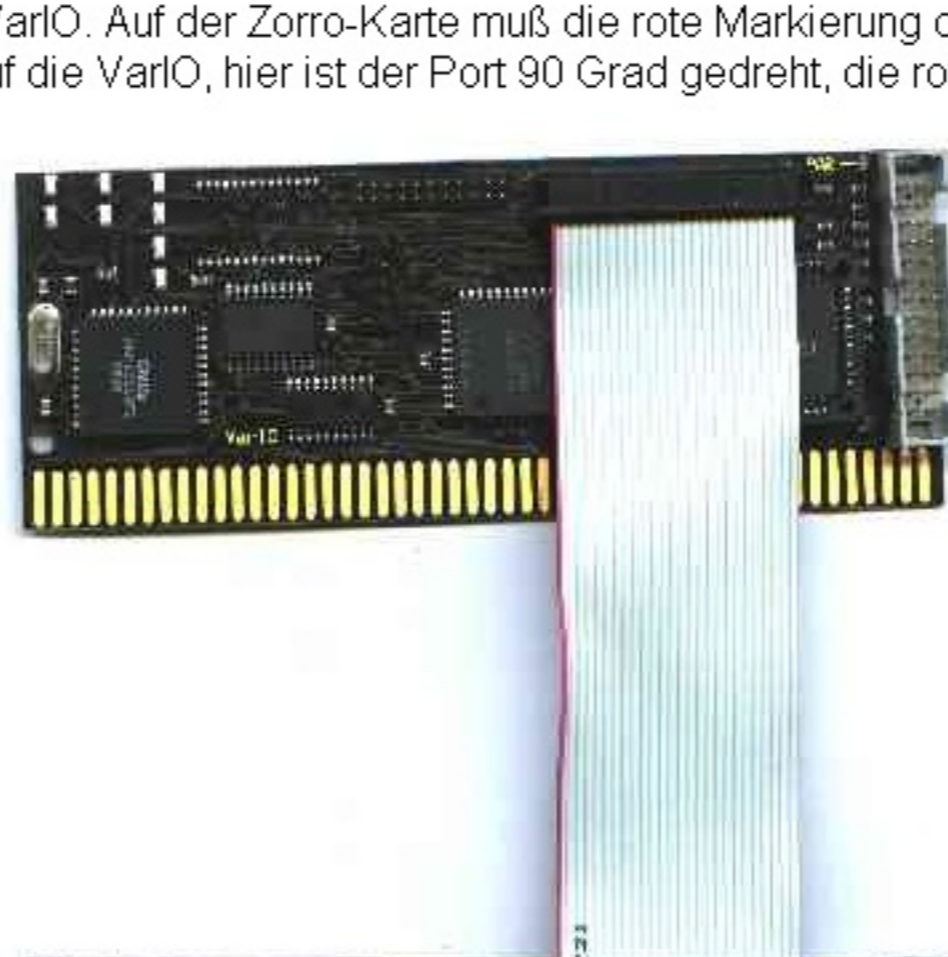
Anschluß einer VarIO auf einer zweiten VarIO
