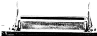
Abbildung 4-4: Zum Einsetzen des Controllers sollten die Klammern des SCSI-Ports an den Stecker geklappt werden.
