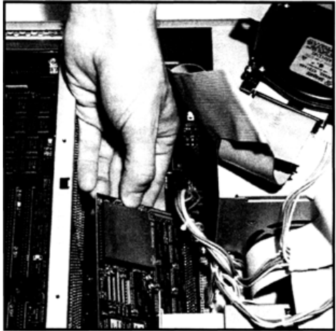
Abbildung 4-2: Durch leichtes seitliches Kippen läßt sich die CPU-Platine nach dem Lösen vom Steckverbinder aus dem Gehäuse entnehmen.
